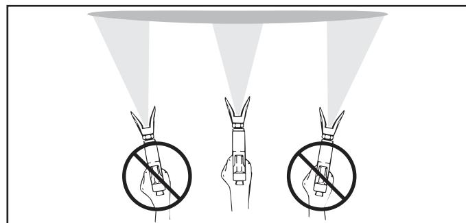
Halten Sie die Spritzpistole senkrecht zur Oberfläche; sonst wird ein Teil der Auftragsfläche dicker als bei anderen Teilen angestrichen.
