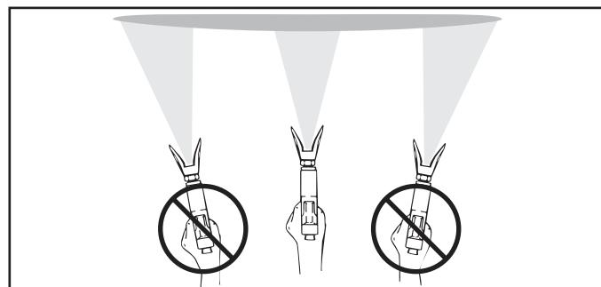
Maintenez le pistolet de pulvérisation perpendiculaire à la surface pour que la couche ne soit pas plus épaisse d'un côté que de l'autre.
