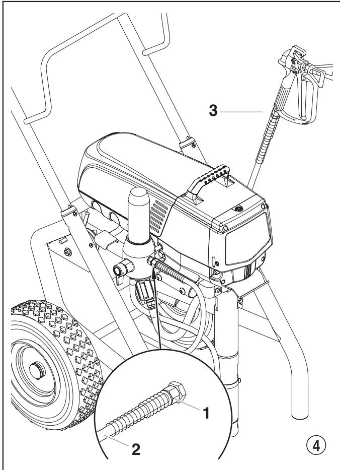
4. Entfernen Sie den Öltankdeckel mit einem geradschlitzigen Schraubenzieher.
