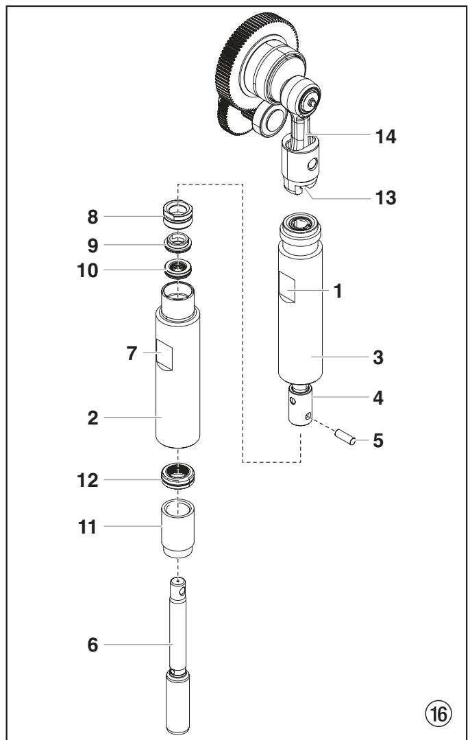
15. Reinigen Sie den oberen Gehäuse (2) und Zylinder (3-5). Überprüfen Sie den oberen Gehäuse und Zylinder auf Beschädigungen und tauschen diesen bei Bedarf aus.
