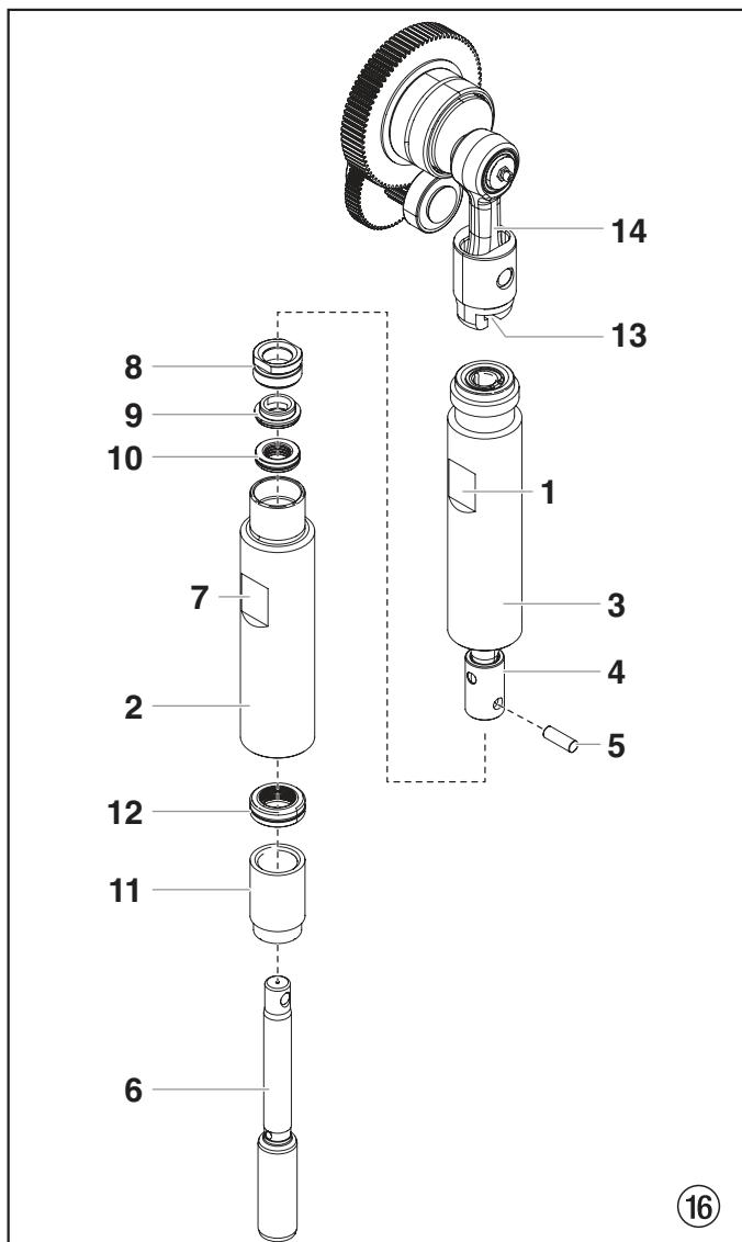
15. Nettoyez le boîtier supérieur (2) et cylindre (3-5). Vérifiez que le boîtier supérieur et cylindre n'est pas endommagé ; remplacez-le si nécessaire.
