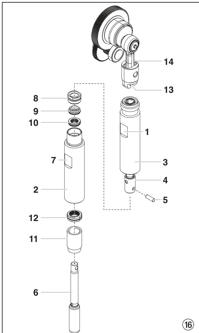
15. Pulire il corpo superiore (2) e cilindro (3-5). Ispezionare il corpo superiore e cilindro e sostituire necessario.
