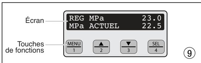
**i** Le bouton de réglage de pression a la priorité sur les réglages du système numérique Digital Electronic Spray Control (DESC). À chaque fois qu'on tourne le bouton de réglage de pression, la pression du pulvérisateur change.
